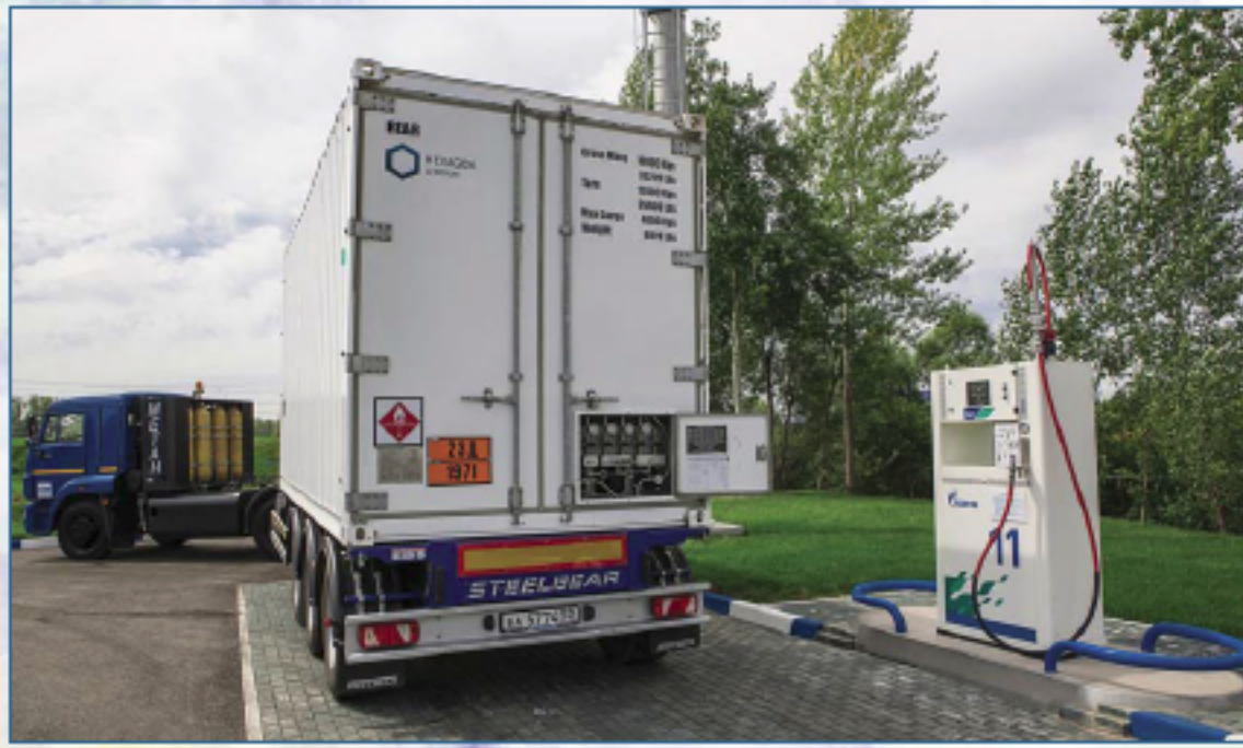
На реконструированной АГНКС оборудована отдельная колонка для наполнения ПАГЗ
